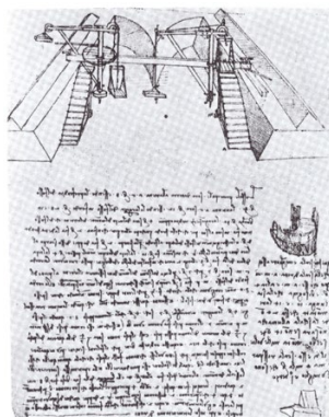
Figura 3 – Leonardo da Vinci. Progetto di sollevamento terra per la costruzione del Naviglio
