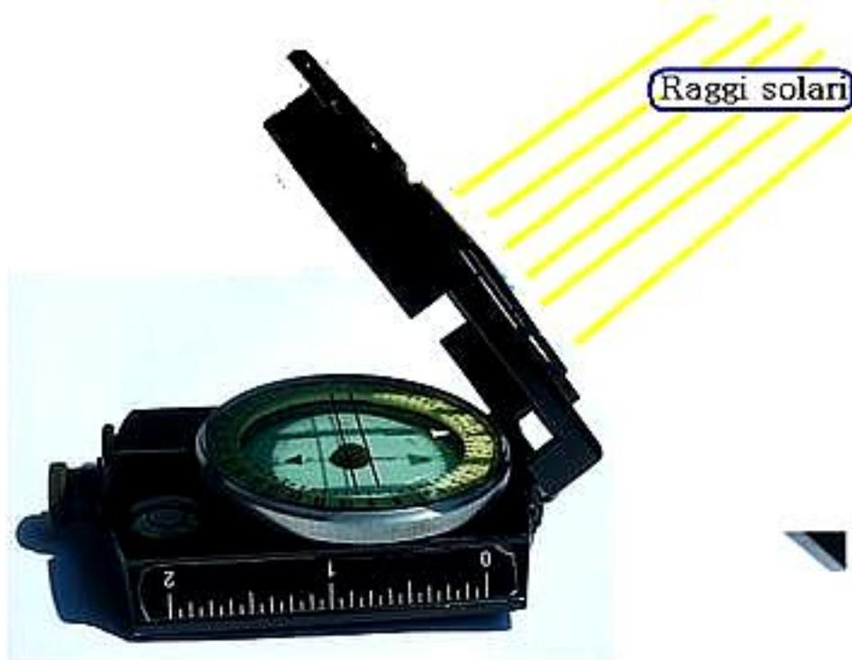
Si dispone la bussola con vetro che contiene il filo di collimazione approssimativamente ortogonalmente alla direzione di arrivo dei raggi solari in modo tale che l'ombra del filo proiettata sull'armilla della bussola, passi per il centro del pivot di sospensione. In questo modo la bussola collima virtualmente il centro del disco solare e quindi la lettura dell'azimut magnetico all'oculare o al prisma fornisce l'azimut magnetico del Sole all'istante  $T$  in cui viene eseguita la misura.
