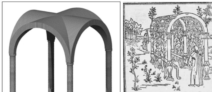
Figura 16 – La volta a crociera all'intersezione di due volte a botte. La sofisticata soluzione nel Polifilo.
