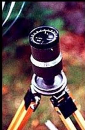
Il nonio dello squadro cilindrico graduato Salmoiraghi permette la lettura di un angolo orizzontale Hz accurato a 5 cc cioè:
