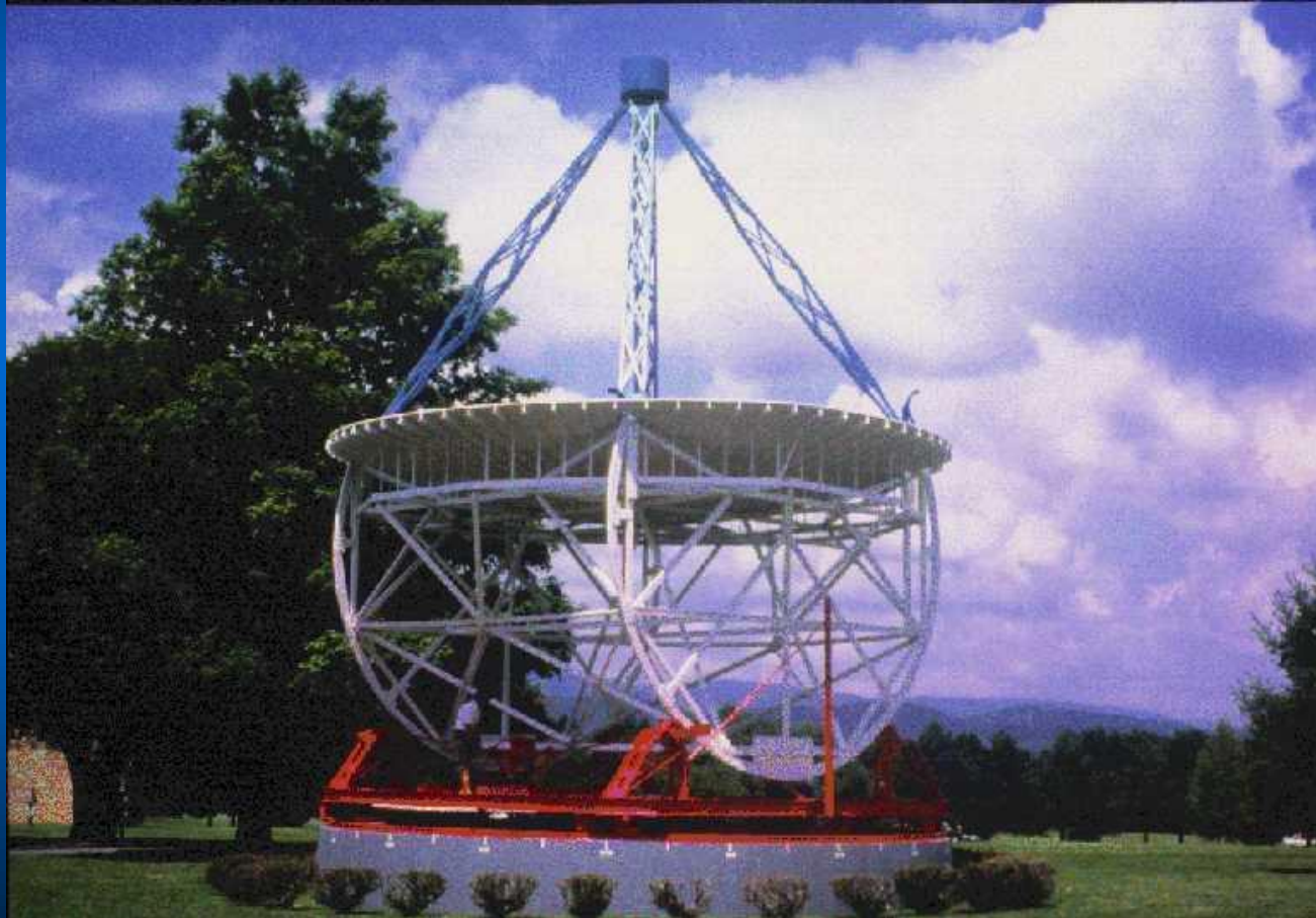
Il riflettore parabolico di Reber (1940): \varnothing 9.5 m, f = 160 MHz
